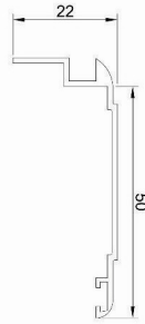
روکوب ۵۰ Suppressed the binding Code : 10027 weight : 0.29 kg/m
