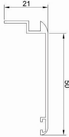
روکوب ۵۰ Suppressed the binding Code : 10026 weight : 0.28 kg/m
